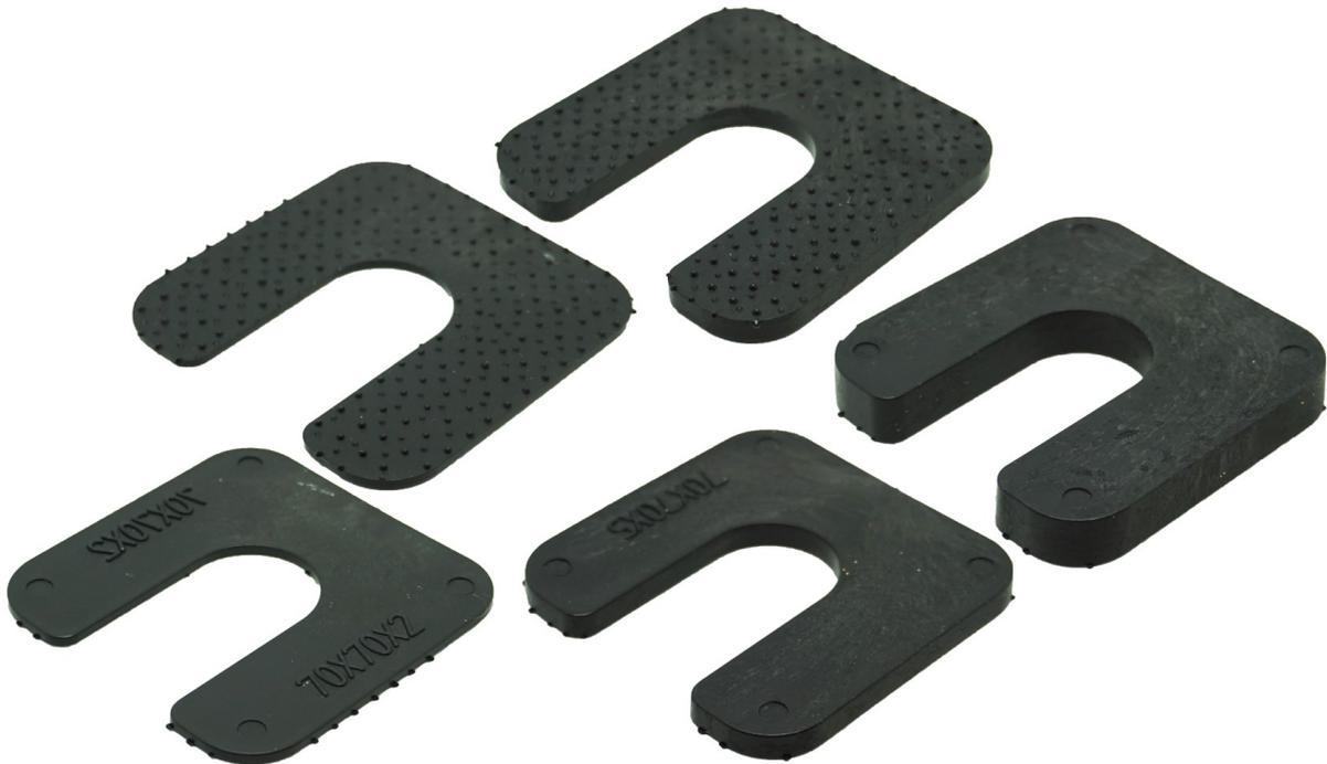
**Descripción:** Producto utilizado para nivelar y calzar en montajes en los que se requiere hacerlo rodeando o abrazando un elemento vertical como postes, barras o perfiles. Con relieve en una cara para evitar desplazamientos. Gran resistencia a la compresión.
