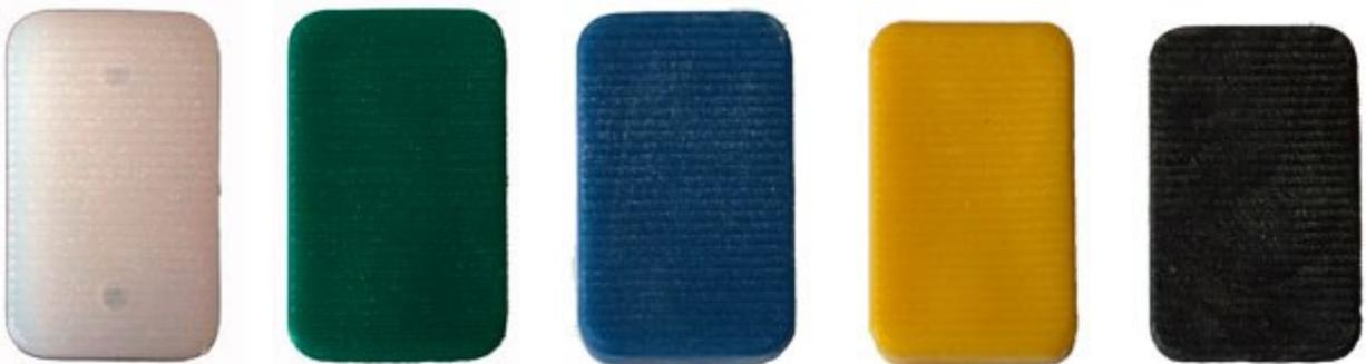
**Descripción:** Calzo especial de plástico que permite evitar el contacto directo entre el vidrio y el metal de la puerta o ventana que reduce considerablemente el riesgo de rotura del cristal y que actúa como interruptor del puente térmico, mejorando el efecto aislante del cerramiento, especialmente cuando se trata de doble o triple cristal con cámara.
